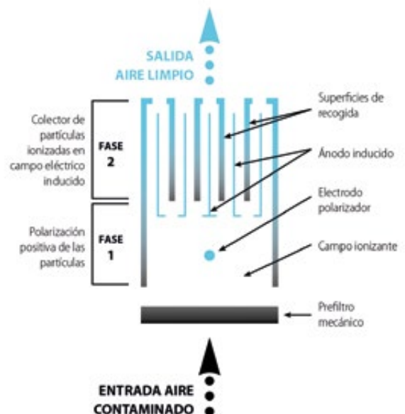
Principio operativo del filtro electrostático Crystall Sabiana IFEMEC
