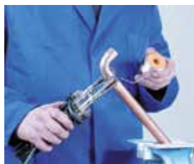
Aplicación de la soldadura fuerte
