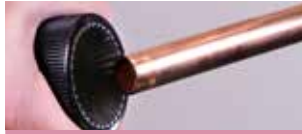
2. Desbarbe y elimine todos los bordes afilados externos
